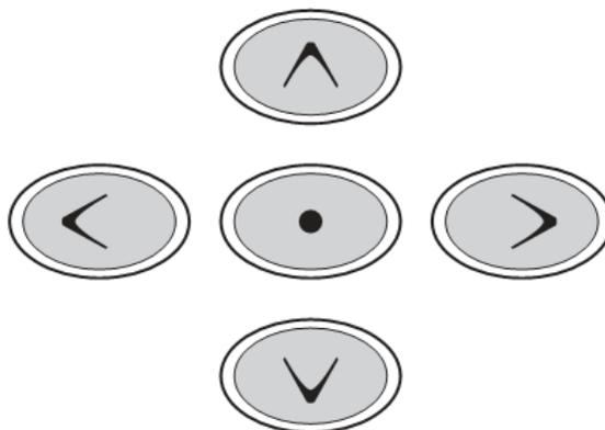
Lorsque les ajustements sont terminés, il faut naviguer sur l'icône Back afin de sauvegarder les données ou Cancel afin de revenir à la programmation précédente. Utilisez la flèche de gauche puis les flèches du haut ou du bas afin de sélectionner et presser sur le bouton central afin d'effectuer l'action désirée.
